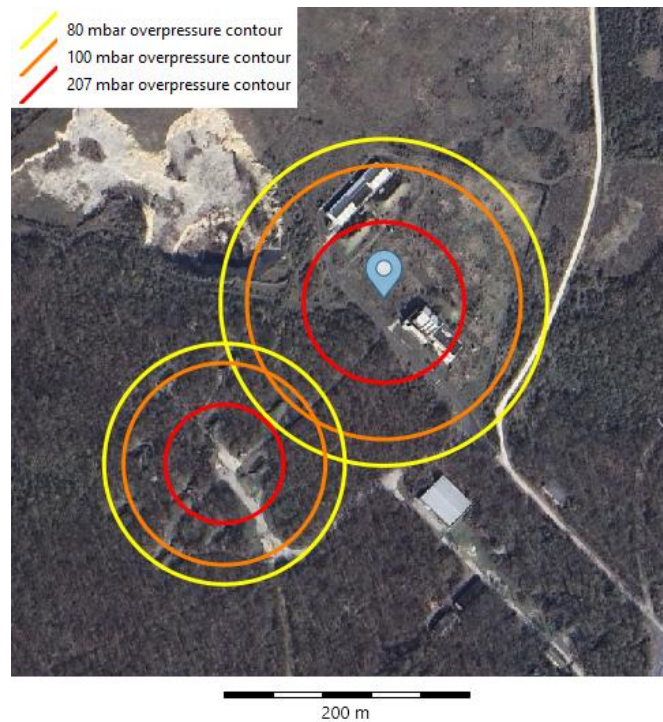
16. ábra: A szállítást végző gépjármű robbanási eseményének hatásövezetei a bevédett raktárak, illetve az 'A' épület raktárainak rakodási helyszínein (TGK.BR_Expl és TGK.A_Expl)
